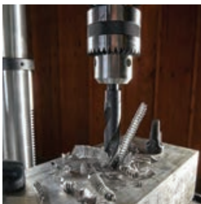
شکل ۳۰-۳- عملیات سوراخ کاری قبل از برقوکاری
