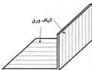
شکل ۲۹-۱- جهت الیاف ورق
